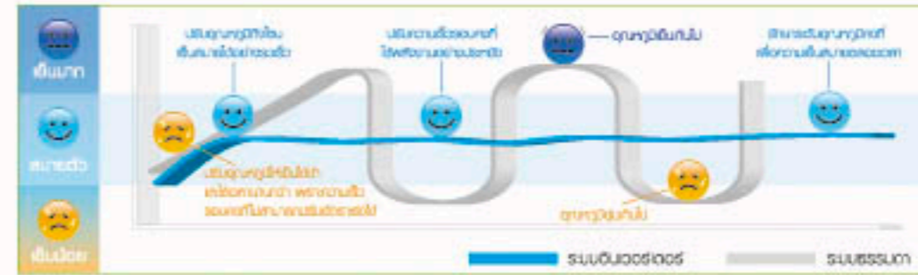
กราฟแสดงความแตกต่างของการทำงานระหว่างเครื่องปรับอากาศแบบธรรมดาและแบบอินเวอร์เตอร์
